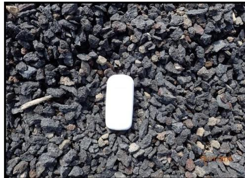
Gambar 16. Foto dari pemanfaatan material lava yang telah dicrusher
