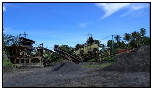
Gambar 20. Pemanfaatan endapan lava batuan vulkanik yang diolah dalam berbagai ukuran menggunakan Crusher oleh PT. INTIMKARA di Desa Nanas Kec. Ibu Selatan untuk material perkerasan jalan raya
